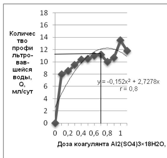
Рисунок 1 - Влияние алюминия сернокислого на фильтрационную способность бурового шлама
